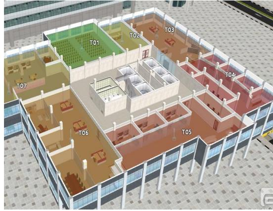
上图：NUCLEUS 能将环境传感器（如能源，温度，湿度）所收集的数据，透过不同的楼层以及跨各楼层不同的房间，以三维体积显示。
